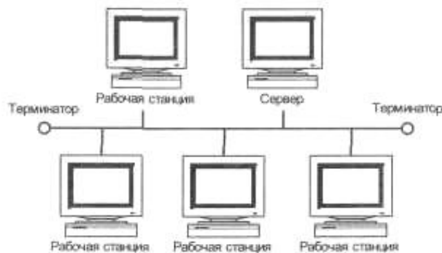
Рисунок 2 - Шинная топология сети
